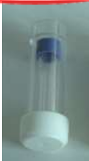
图 A.4 采样的管件及保护用套管实物图
